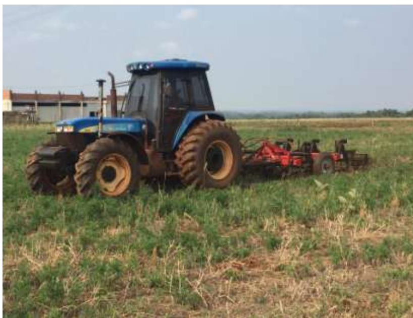
FIGURA 3. Trator utilizado para realizar os diferentes tipos de prepare de solo, com implemento de escarificação.
