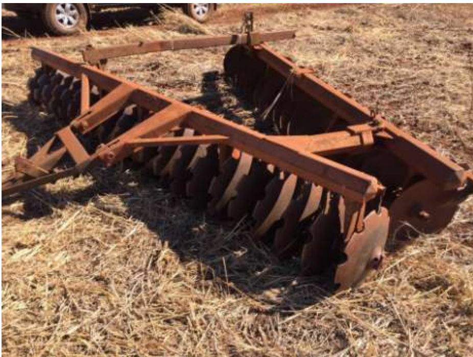
FIGURA 5. Grade grade destorroadora-niveladora, tipo off-set, de arrasto.
