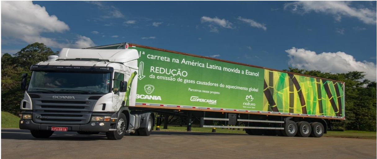
FIGURA 3. Scania P270 movido exclusivamente por etanol em motor ciclo diesel.
