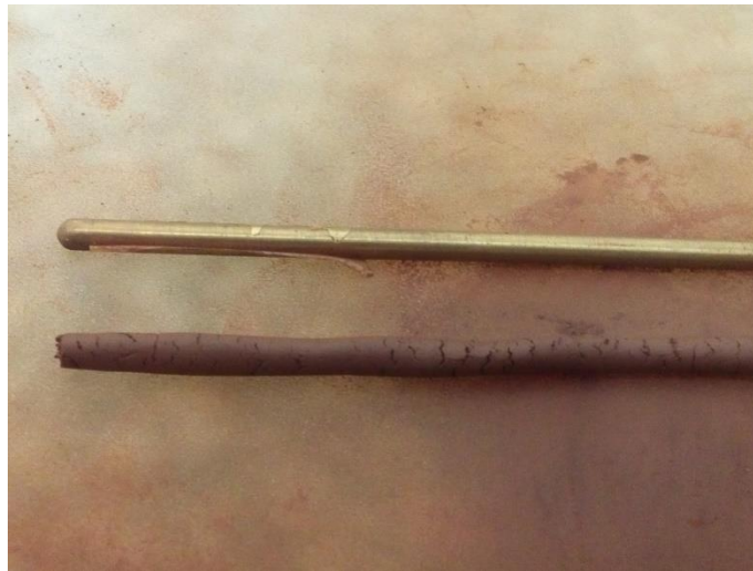
Figura 3. Placa de vidro esmerilhada e gabarito para realização do ensaio do Limite de Plasticidade.
