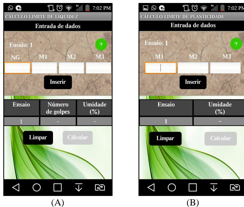
Figura 9. Telas para realizar o cálculo do Limite de Liquidez (A) e do Limite de Plasticidade (B).
