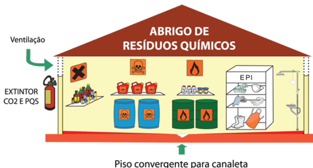
Figura 5 - Abrigo de resíduos químicos. Fonte: Resol (2017).
