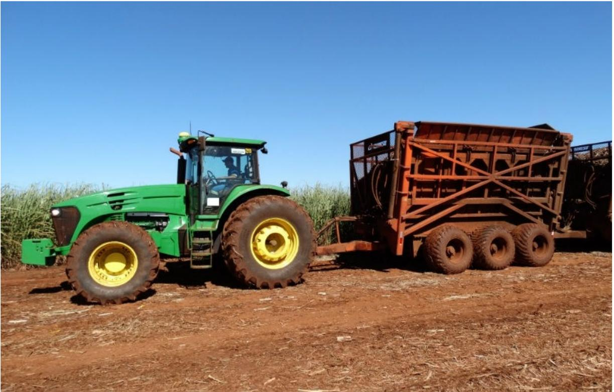
Figura 20 - Transbordos da empresa acoplados a tratores. Fonte: Imagem fornecida pela empresa.
