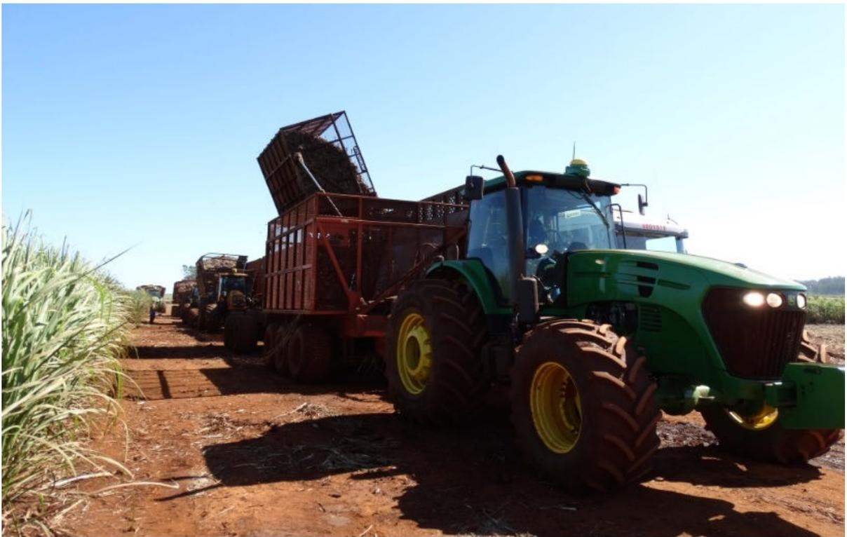
Figura 23 - Transbordos da empresa realizando o processo de carregamento de cana do caminhão (rotação do mancal). Fonte: Imagem fornecida pela empresa.
