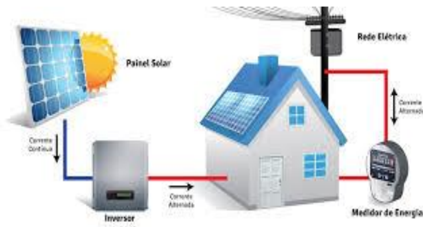
Figura 3 - Ilustração de um sistema fotovoltaico conectado à rede.
