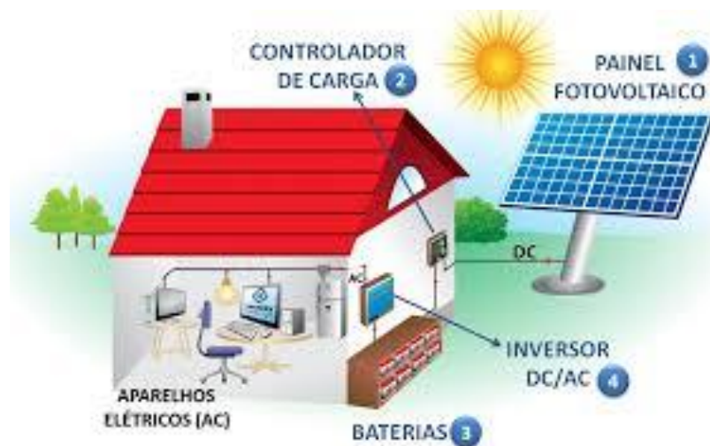
Figura 2 - Ilustração de um sistema Off Grid
