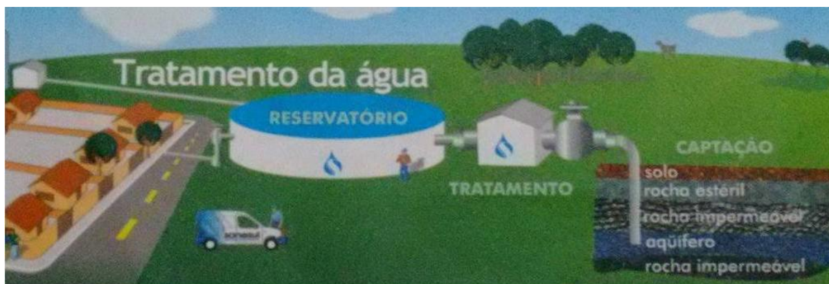
Figura 4- Processo de captação, tratamento, reservatório e distribuição da água potável. Fonte: Fonte adapta da Sanesul (2016)
