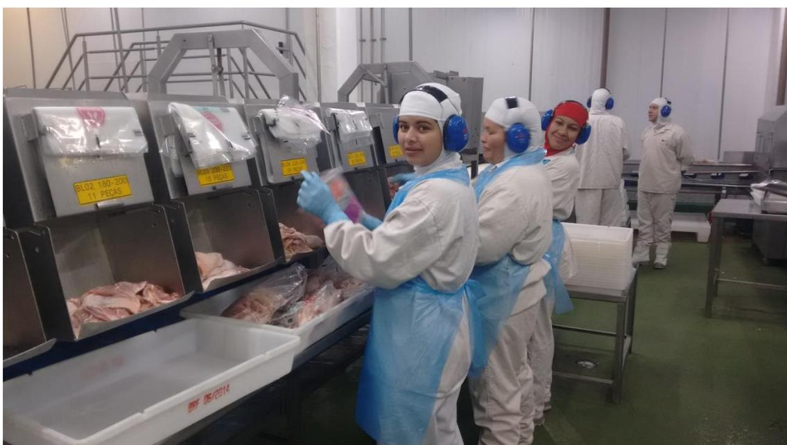
Figura 6: Atividade de empacotar na máquina classificadora por gramatura.
