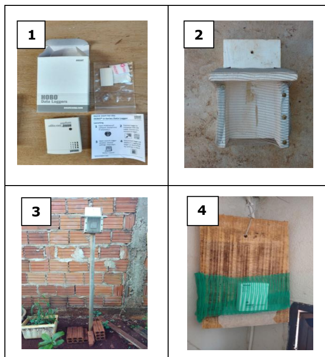
Figura 5: Materiais utilizados na pesquisa: (1) data loggers, (2) tela de polietileno, abrigos de madeira, (3) abrigo externo instalado, e (4) abrigo interno instalado.
