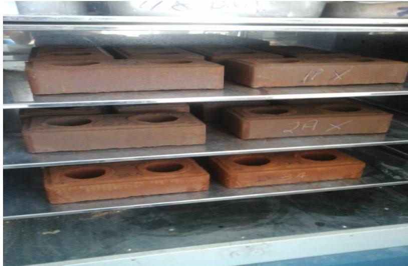
FIGURA 5. Secagem dos tijolos em estufa de circulação forçada.
