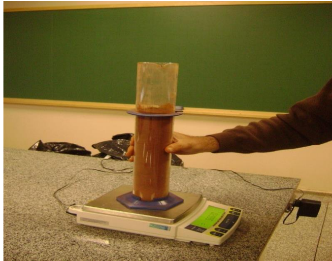
FIGURA 3. Determinação da massa unitária
