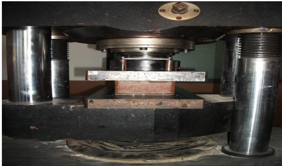
FIGURA 9. Ensaio de compressão simples dos tijolos ecológicos.
