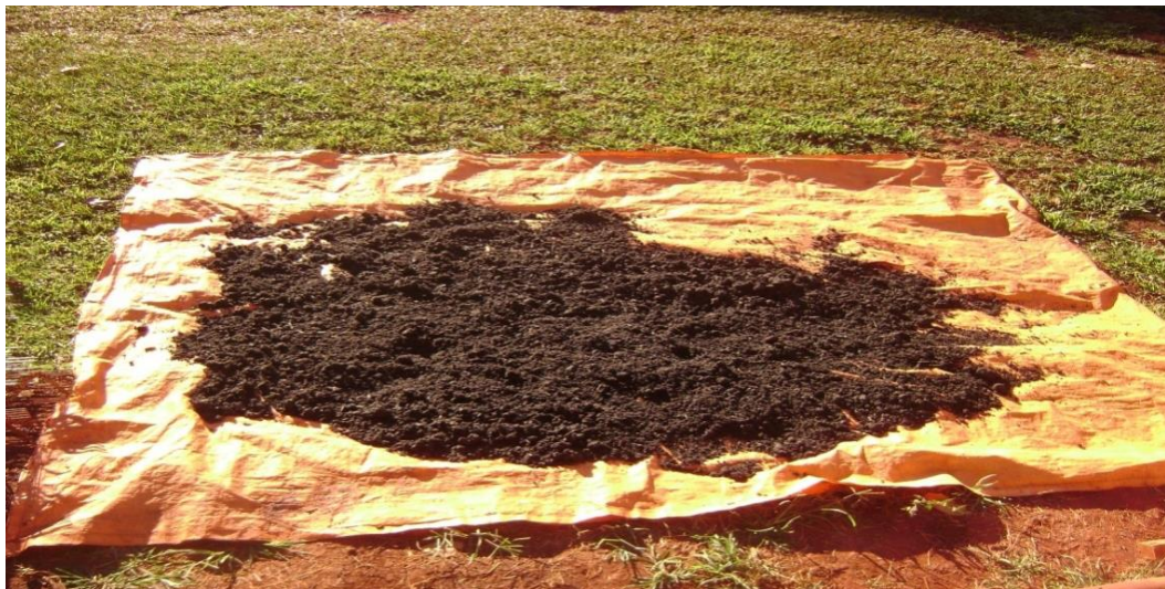
FIGURA 2. Secagem da cinza ao ar livre.
