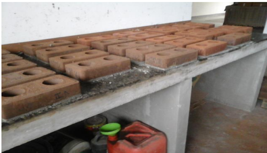
FIGURA 8. Tijolos capeados com argamassa.
