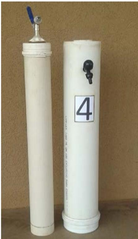
Figura 01: Vista do microbiodigestor.
