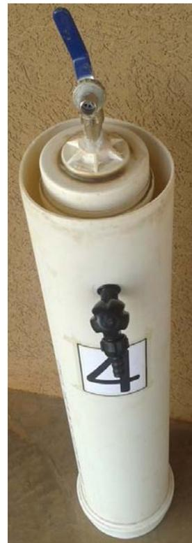
Figura 02: Microbiodigestor pronto para uso.
