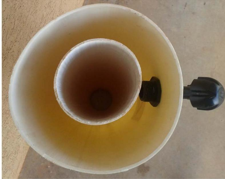
Figura 03: vista interna superior do microbiodigestor.
