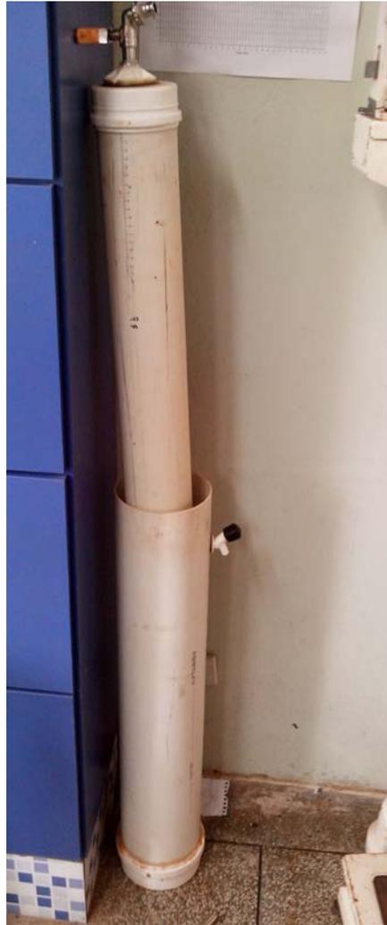
Figura 04: Microbiodigestor em funcionamento.
