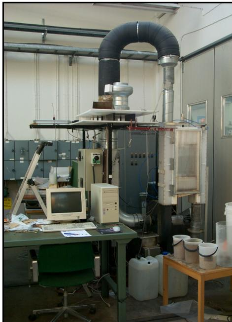
**A6.** Equipamento para tratamento de sementes com vapor aerado (Forsberg *et al.*, 2001).
