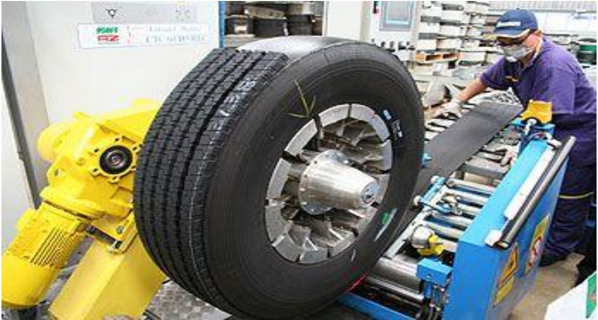
Figura 3: Processo de recapagem
