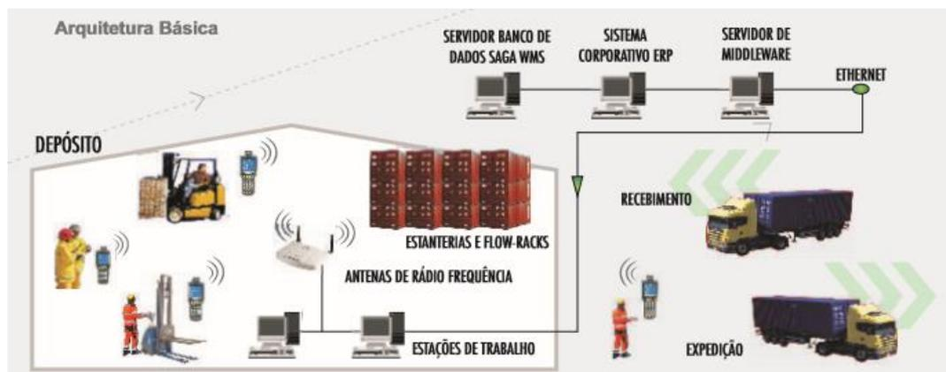
Figura 3.1. – Funcionamento básico do Sistema WMS
