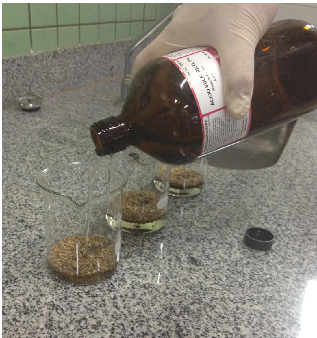
Figura 5 – Tratamento com ácido sulfúrico concentrado
