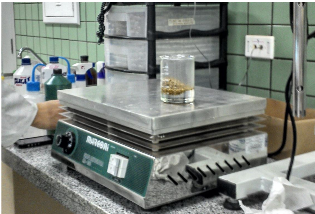
Figura 4 – Tratamento térmico com água a 70°C
