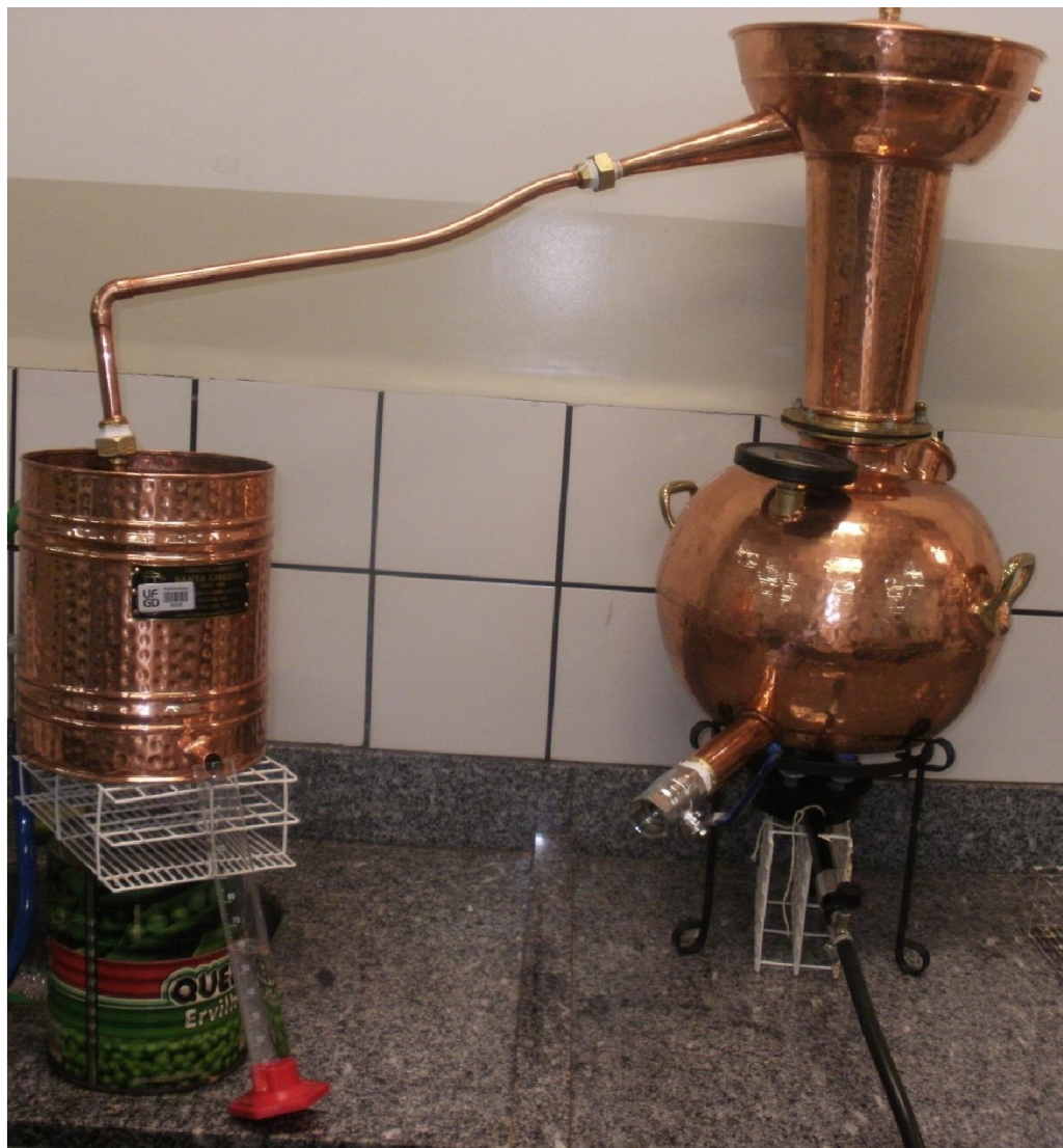
Fotografia 3. Alambique de cobre utilizado para realizar a destilação.
