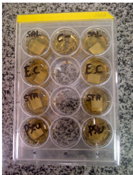
Figura 1. Microplaca de poliestireno com cupons de aço, pronta para o teste
