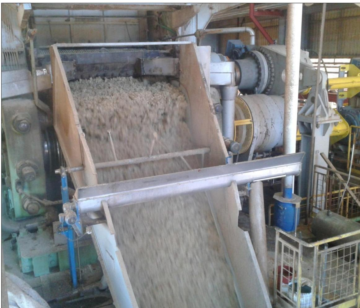
Figura 4.5: Coletor contínuo de bagaço.
