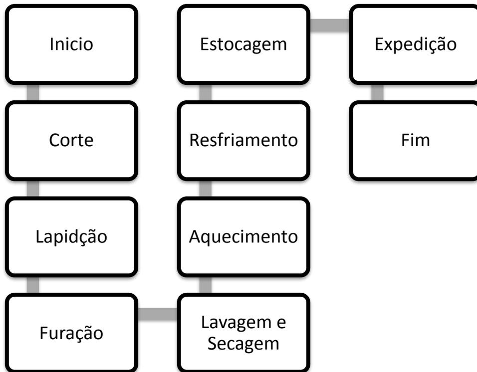
Figura 8 - Fluxograma do processo
