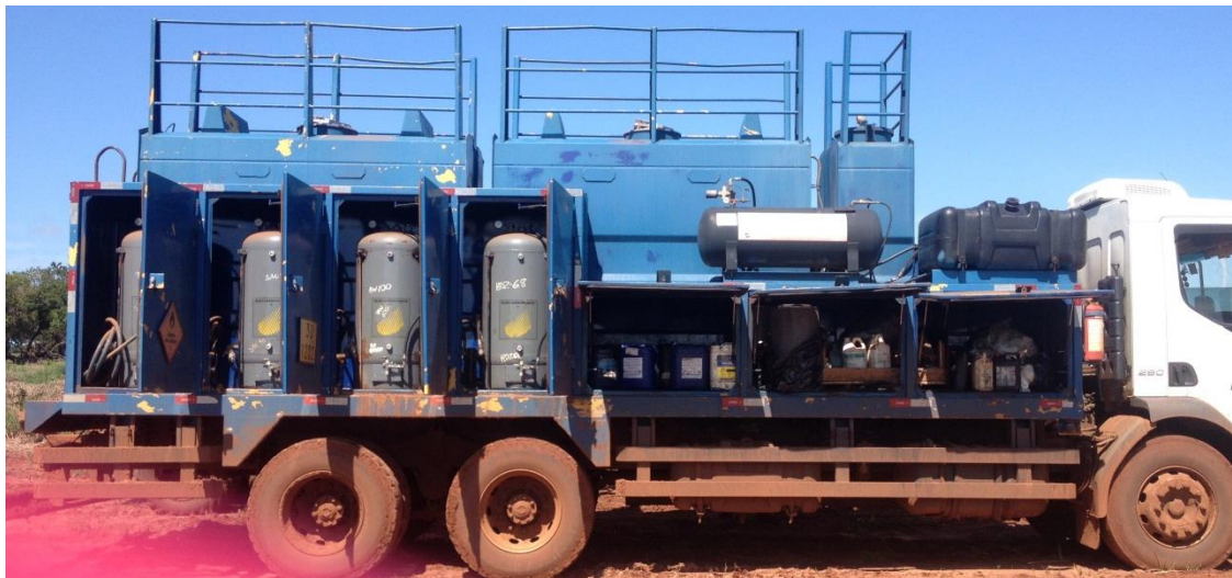
Figura 4 – Tanques de armazenamento de combustíveis e dos óleos no caminhão Fonte: Autoria própria
