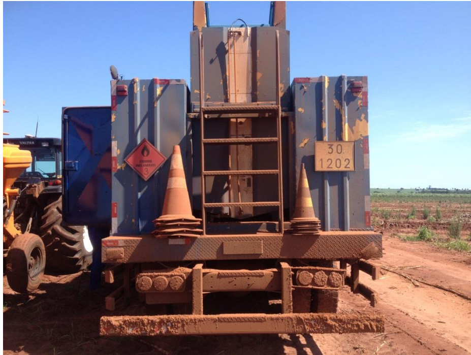
Figura 6 – Equipamentos de Proteção Coletiva no caminhão comboio Fonte: Autoria própria
