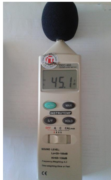
FIGURA 5 – Decibelímetro DEC 460 Fonte: Disponibilizado pelo autor
