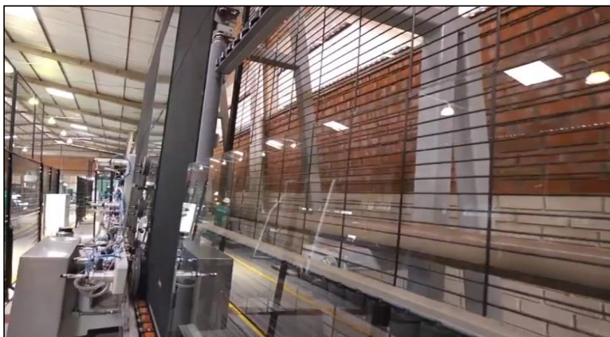
Figura 15: Linha de lapidação automática
