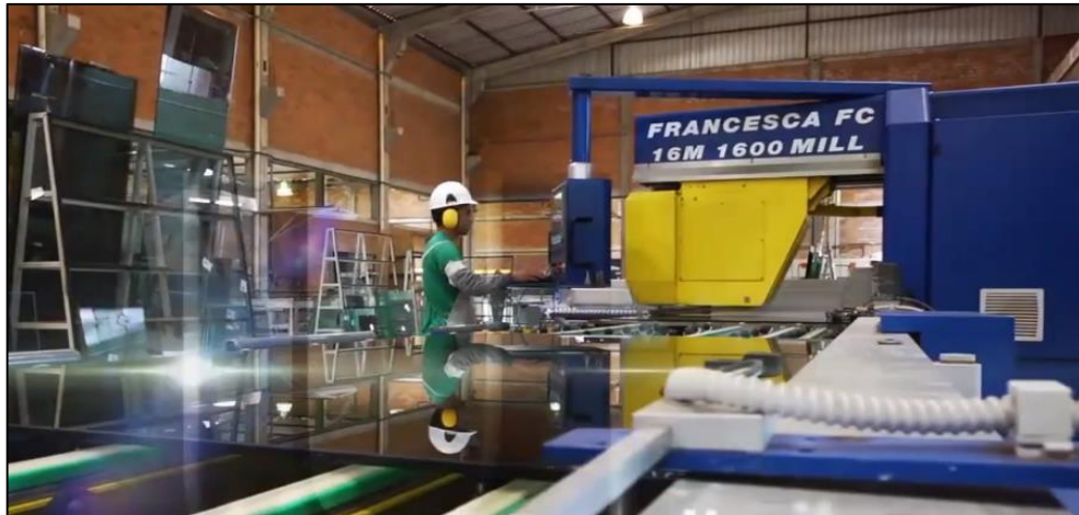
Figura 16: Linha de furação automática
