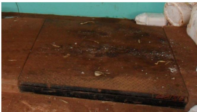
Figura 13: Balança para pesagem dos fardos
