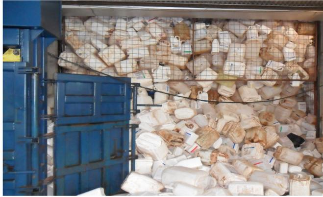
Figura 11: Sistema de saída das embalagens através de aberturas na grade de contenção
