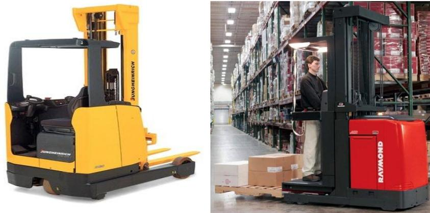
Figura 5– Empilhadeira retrátil à esquerda, e o separador de pedidos a direita.
