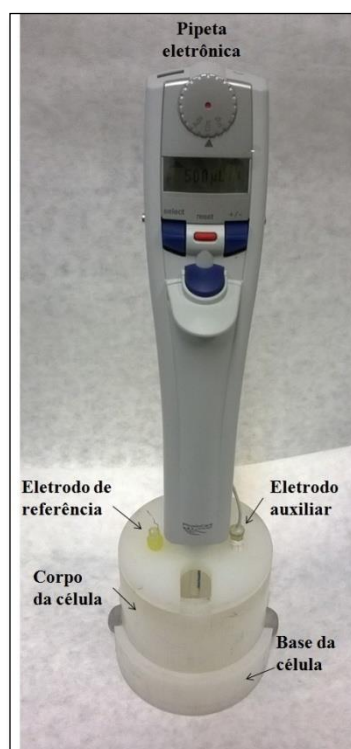
Figura 2 - Imagem em perspectiva da célula eletroquímica de BIA e o injetor (pipeta eletrônica).
