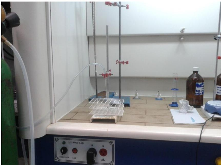
Figura 9 Sistema de secagem utilizando nitrogênio
