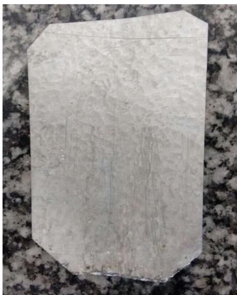
**Figura 39** - Chapa galvanizada imersa na glicerina bidestilada após dois meses.
