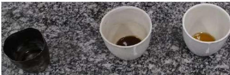
**Figura 32** - Cadinhos que foram colocados no forno mufla para teste de combustão espontânea.
