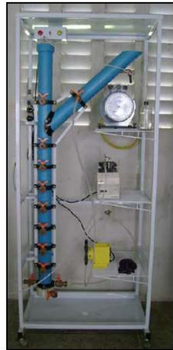
**Figura 22** - Biodigestor em escala laboratorial
