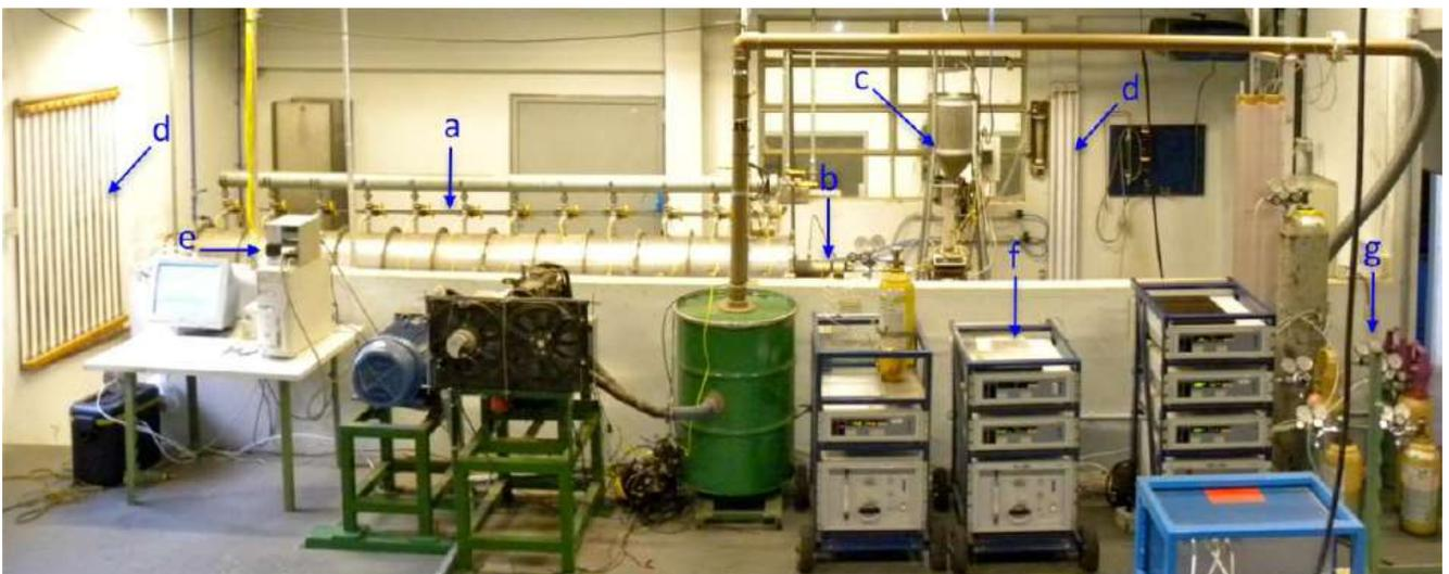
**Figura 16** - Bancada experimental usada para os ensaios de combustão de Cordoba (2011), a - fornalha; b - queimador; c - unidade de aquecimento e pré-acondicionamento de glicerina; d - manômetros diferenciais; e - sistema de aquisição de dados; f - analisadores de gases; g = gases de calibração.
