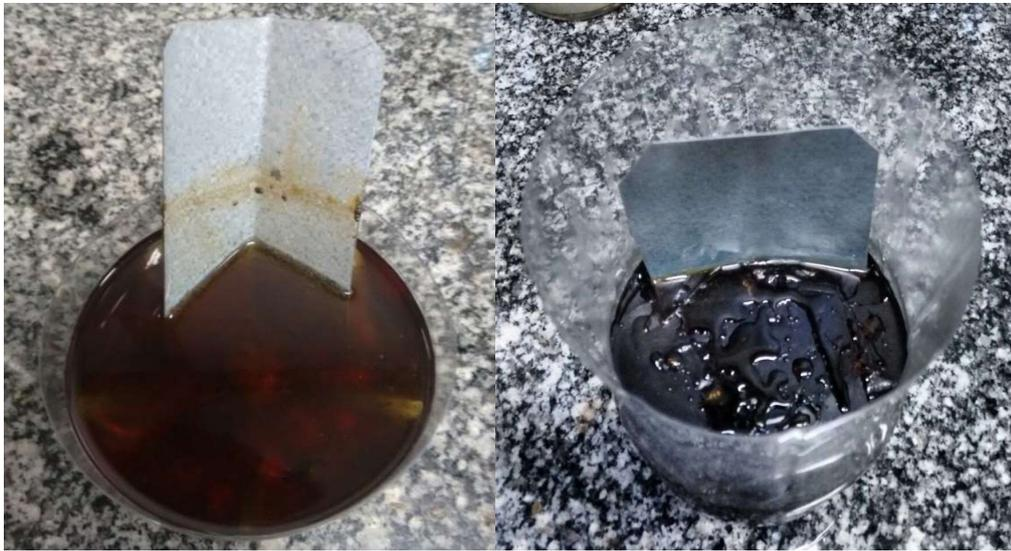
**Figura 34** - Chapa de aço galvanizado imersa em glicerina loira à esquerda e bruta à direita.
