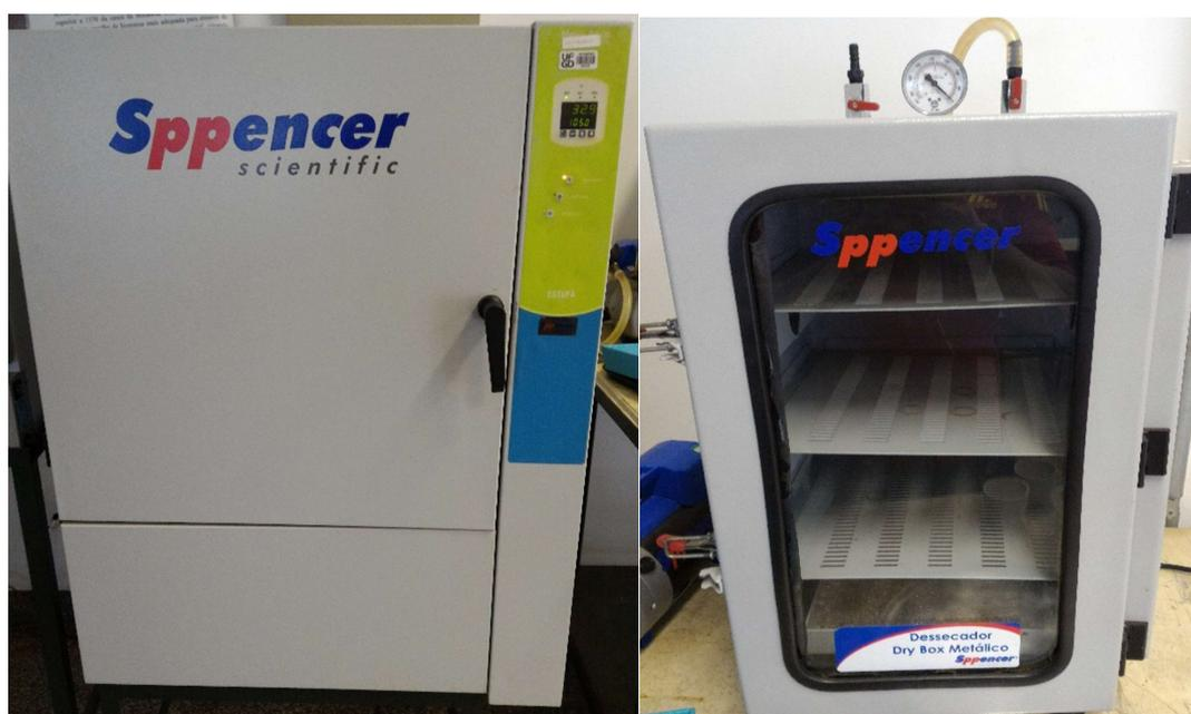
**Figura 31** - Estufa à esquerda e secador a vácuo à direita.
