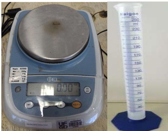
**Figura 29** - Balança de precisão à esquerda e proveta graduada à direita.
