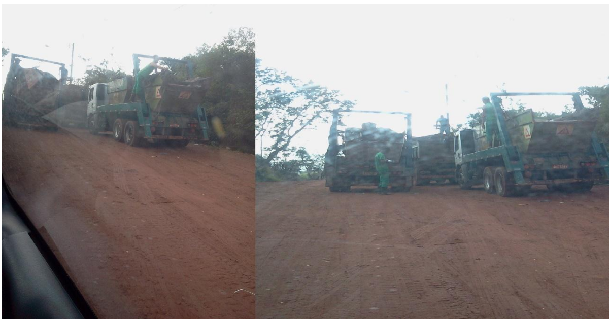
Figura 4 - Inspeção e classificação de caçambas de resíduo de construção civil classe A após pesagem
