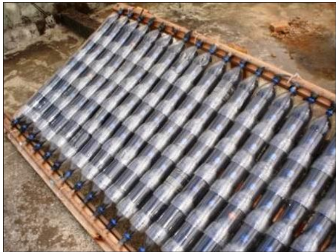
Figura 11 – Coletor Solar Descartável.
