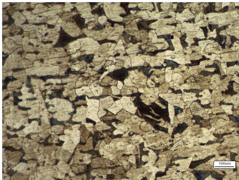
Figura 17 – Centro amostra Aço 1010 com tratamento de 120 minutos aumento de 40x
