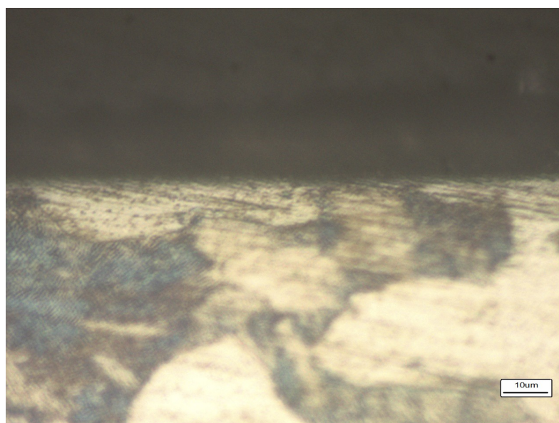
Figura 30 – Superfície amostra Aço 1020 com tratamento de 120 minutos aumento de 400x
