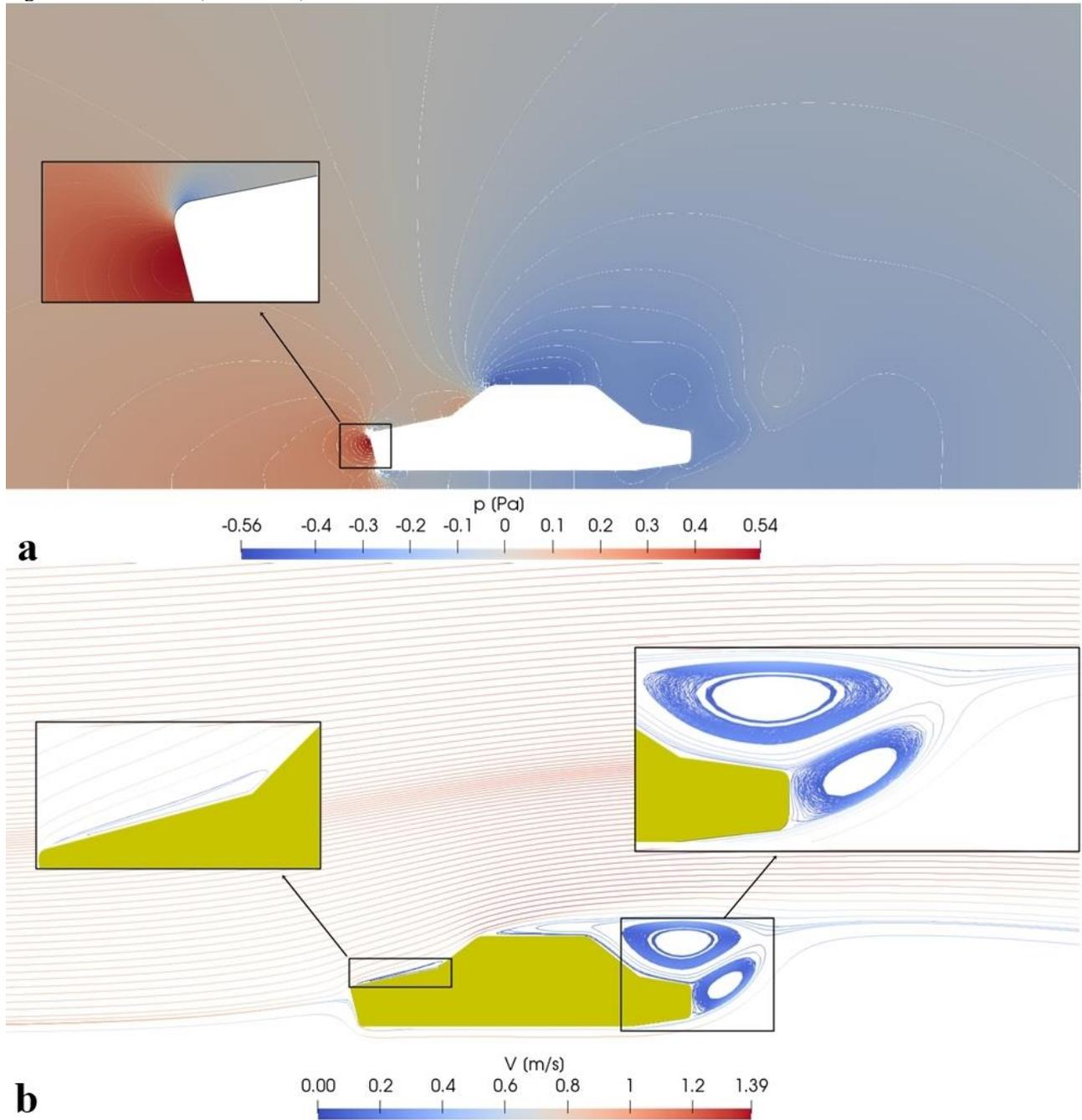
No trajeto B, o escoamento na porção inferior se desloca na aresta entre a face frontal e a base. Ele se desenvolve como o escoamento em dutos durante toda a base, independente do  $Re$ , estudado. No rebaixo posterior, para  $Re = 1800$  observa-se a formação de uma região de recirculação com recolamento da camada limite ainda no rebaixo posterior com subsequente descolamento na aresta entre o rebaixo e a face posterior. Esta região de recirculação é menos evidente para  $Re = 18000$ .
