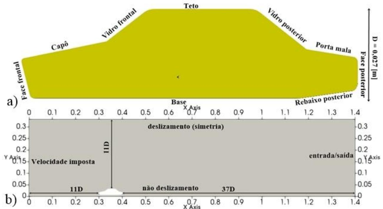
A malha (Fig.2), foi construída usando 204 mil elementos hexaédricos com o auxílio da ferramenta *snappyHexMesh* do OpenFOAM 6.0. O maior nível de refinamento ficou nas regiões de parede, ou seja, no limite inferior do domínio de cálculo e no corpo de prova (carro).
