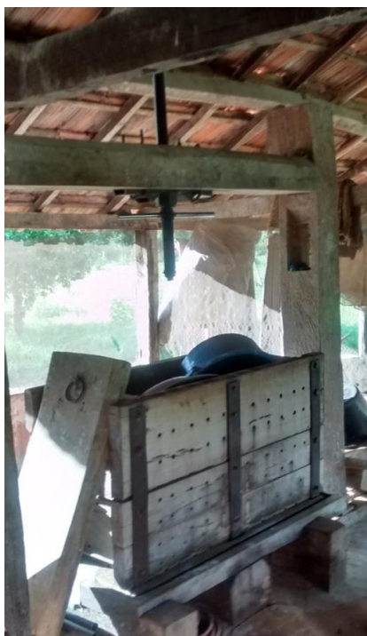
Foto 13 – Município de Anastácio Prensa utilizada para a produção da farinha de mandioca em unidade de produção camponesa da Colônia Pulador
