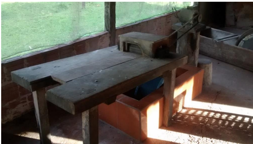
Foto 12 – Município de Anastácio Triturador utilizado para a produção da farinha de mandioca em unidade de produção da Colônia Pulador
