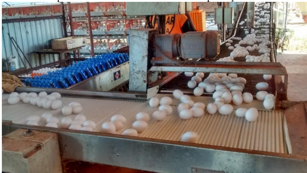
Foto 34 – Município de Terenos Esteira rolante para a coleta dos ovos em unidade de produção da Colônia Jamic
