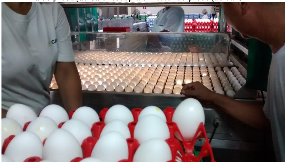
Foto 49 – Município de Terenos Linha de produção da ovoscopia em setor de produção da CAMVA
