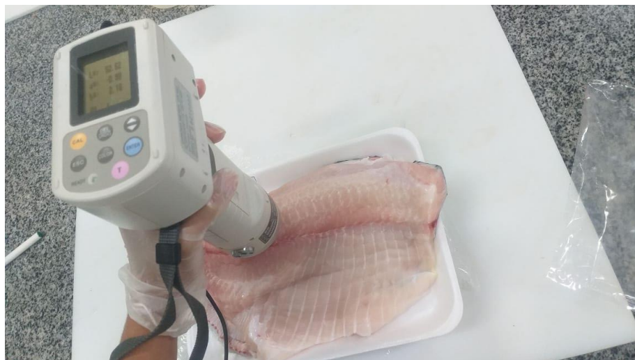
FIGURA 3. Medida do parâmetro coloração do filé (cor vermelha, cor amarela e luminosidade).
