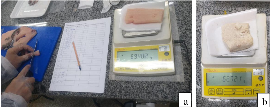
FIGURA 5. (a) pesagem de 70g de amostra do filé para análise de PPC; (b) pesagem da amostra do filé após o banho-maria.
