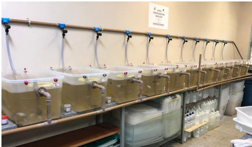
FIGURA 1. Sistema de recirculação de água para o cultivo de alevinos de tilápia do Nilo. Fonte: O autor (2019).
