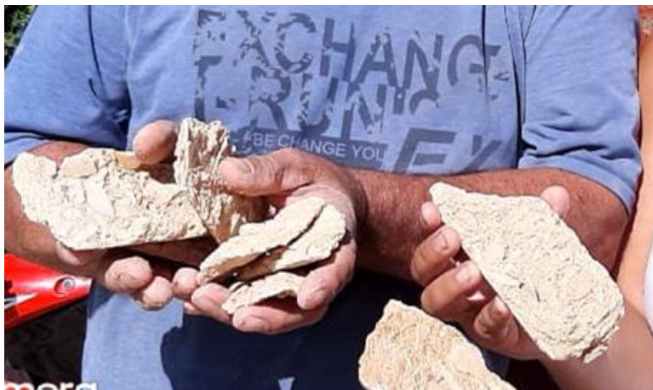
Figura 4 - Sedimentos de calcário retirados das tubulações de água no assentamento Taquaral. Foto: cortesia, Geovanny dos Santos (2020)
