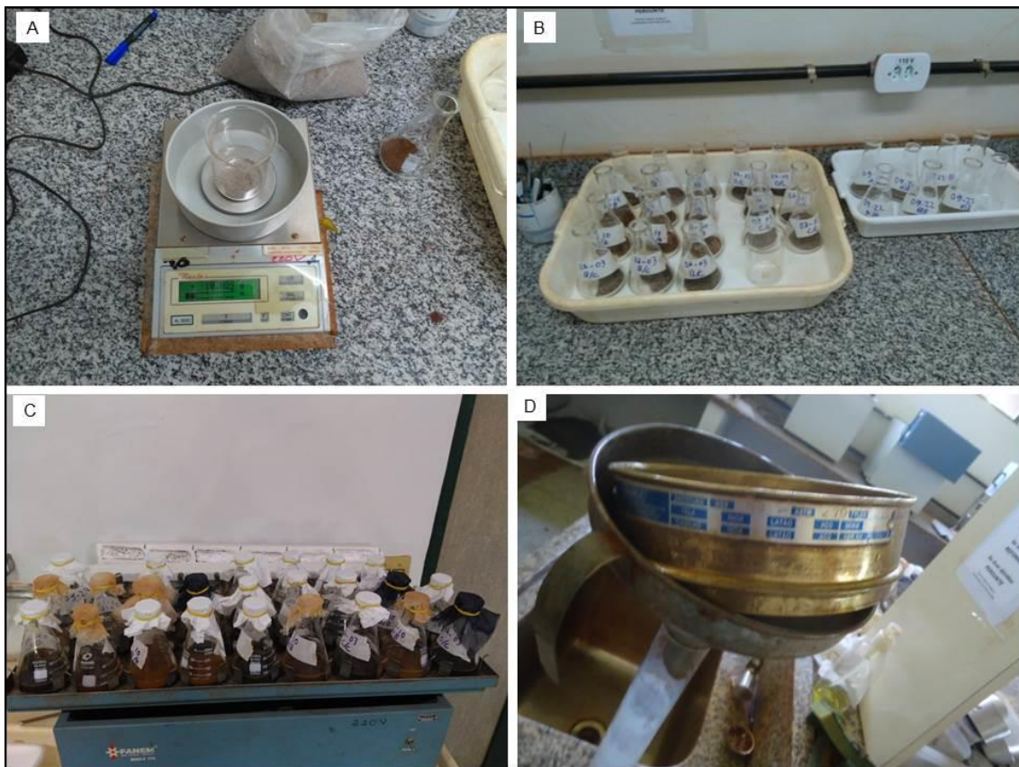
Figura 20. Pesagem e Agitação das amostras de solo. A e B) Amostra de solo e areia sendo pesadas em balança semi analítica e organizadas em Erlenmeyer com NaOH para agitação mecânica. C) Mesa agitadora utilizada para agitação e dispersão das partículas. D) Conjunto de peneira com abertura de 0,53mm, funil e proveta de 500ml para lavagem do Erlenmeyer e separação das frações de areia, argila e silte. Fonte: O Autor (2018)
