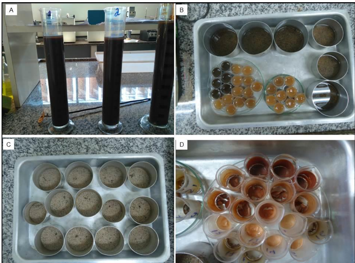
Figura 21. Processo de decantação e estufa. A) Proveta de 500ml após agitação manual. B) Lata de alumínio com a fração areia e becker de 10ml pipetado contendo a fração argila. C e D) Areia e argila retirados da estufa. Fonte: O Autor (2018).
