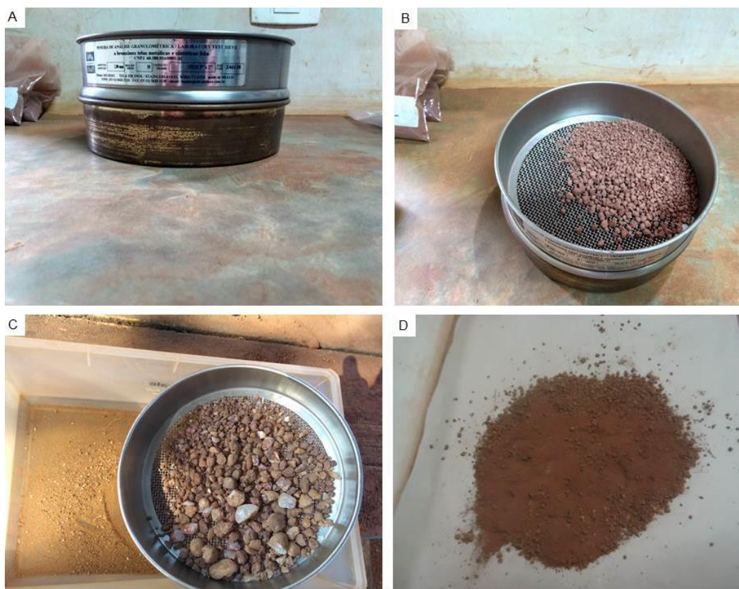
Figura 19. Instrumentos usados para peneiramento. : A) Peneira de 2mm acoplada ao fundo, com recipiente utilizada para separação das partículas. B e C) Partículas maiores que 2mm retidas na peneira. D) amostra de solo peneirada preparada para quarteamento. Fonte: O autor (2018).
