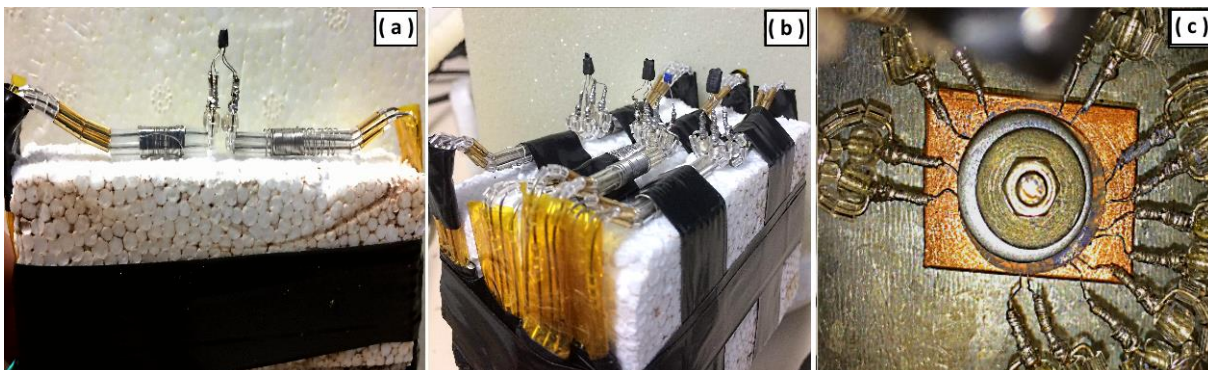
Figura 44 - Detalhe dos processos de calibração entres os sensores: (a) exemplo da junção do par PT100; (b) todos os pares agrupados, prontos para serem inseridos na caixa térmica; (c) sensores presos em bloco de cobre para o processo de calibração de referência.
