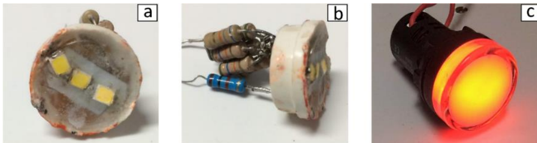
Figura 21 - Detalhamento construtivo do indicador luminoso. (a) Três super LED ligado em série e resinado, (b) Resistores associado para suportar o PWM de 179Vcc, (c) Indicador visual finalizado em funcionamento.
