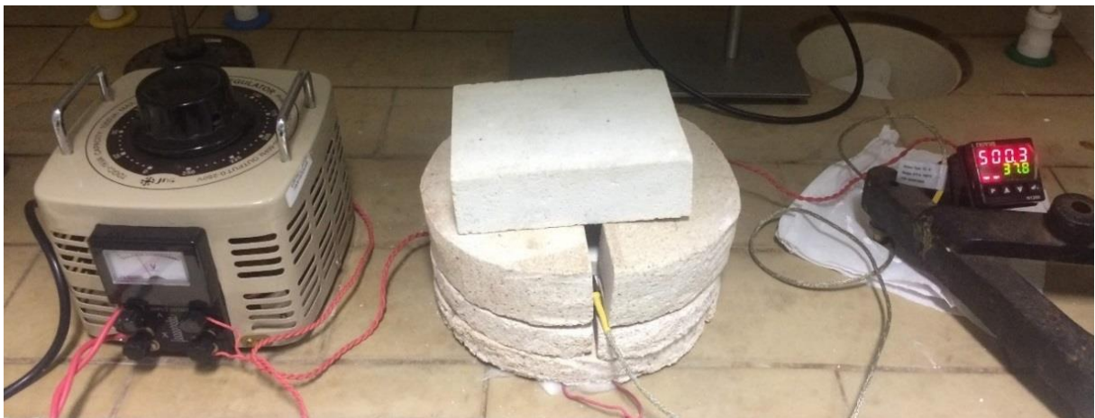
Figura 11 - Imagem fotográfica do ensaio inicial da resistência para verificação da temperatura.
