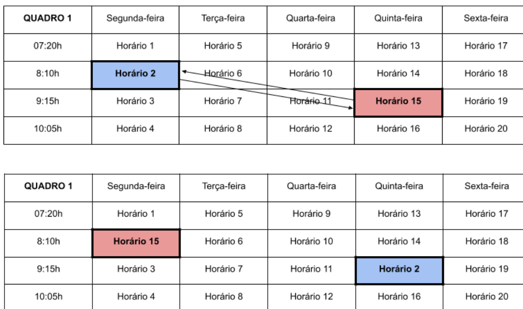
Figura 5. Diagrama da mutação de troca aleatória de células.
