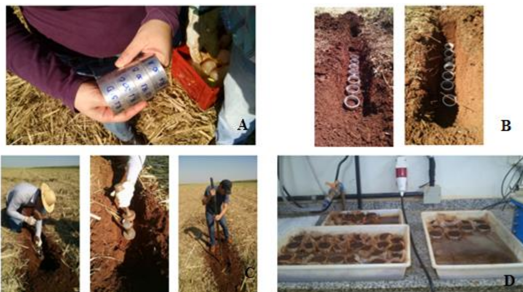
Figura 6. Coleta de solo nas parcelas após a colheita mecanizada da cana-de-açúcar com posterior saturação dos anéis em laboratório. A: Marcação dos anéis com respectivos tratamentos; B: Disposição dos anéis nas duas profundidades; C: Retirada dos anéis com auxílio de um castelinho e D: Amostras saturadas.
