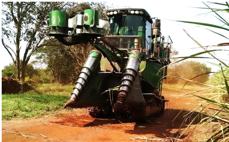
Figura 3. Colhedora 3520, com 335cv de potência bruta e 17 Mg de massa.
