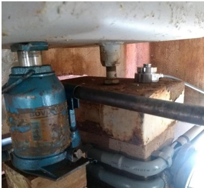
**FIGURA 2.** Instalação da célula de carga do lisímetro.
