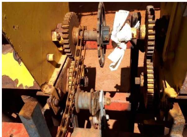
FIGURA 9. Solução proposta, que resolveu o problema relacionado a regulagem do adubo.
