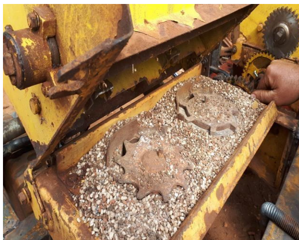
FIGURA 10. Modelo de coroa mais estreito foi a que melhor atendeu a demanda de adubação necessária para área em questão.
