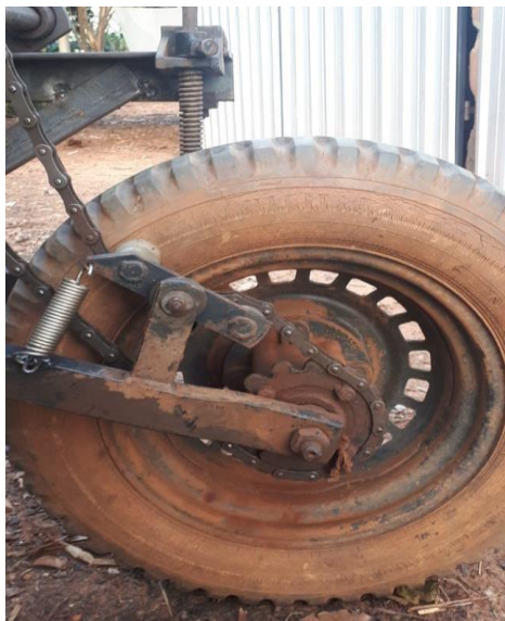
FIGURA 7. Mola que necessitou ser substituída devido ao arraste dos pneus em terrenos mais ondulados da área.
