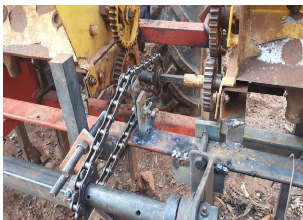
FIGURA 8. Coroa que teve necessidade de locada ao eixo superior.
