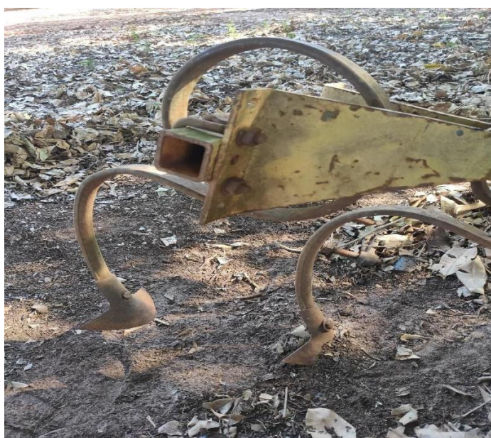
FIGURA 5. Modelo testado e descartado, devido ao funcionamento não atender ao que era esperado para o projeto.
