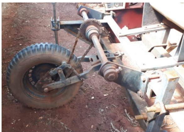
FIGURA 21. Detalhamento do órgão ativo responsável pela aplicação de adubo.
