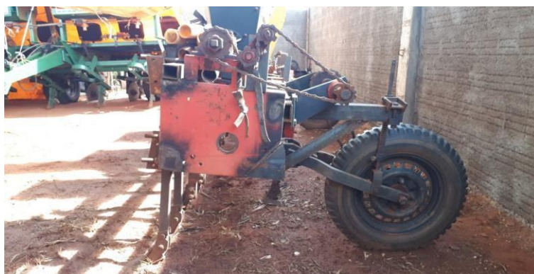
FIGURA 20. Vista lateral do cultivador-adubador adaptado, detalhando o sistema de transmissão para acionar a caixa de adubação.
