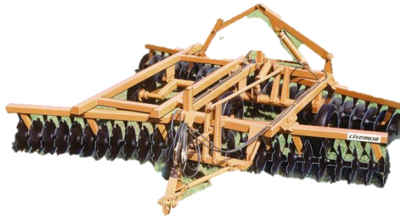
Figura 5. Grade média destorroadora-niveladora Civemasa – GDR. Fonte: Civemasa (2021).
