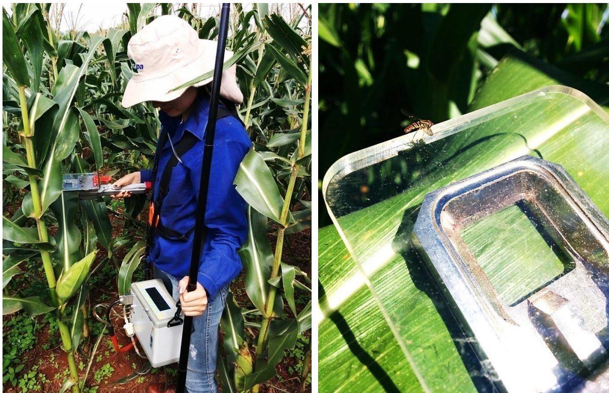
FIGURA 2. Uso do IRGA na avaliação das trocas gasosas no estágio de florescimento do milho. Dourados-MS, 2018.
