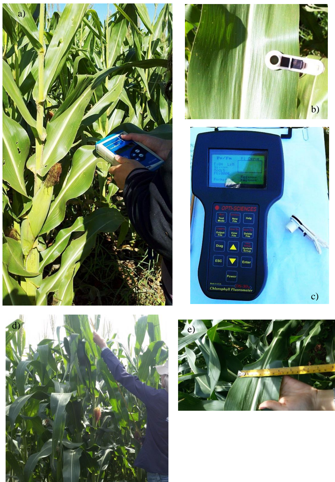
FIGURA 4. a) Uso do medidor portátil ClorofiLog na avaliação do índice de clorofila; b) uso do fluorímetro na avaliação da fluorescência da clorofila a ; c) fluorímetro portátil; d) e e) medição do comprimento e largura da folha para determinação da área foliar por planta. Dourados-MS, 2018.
