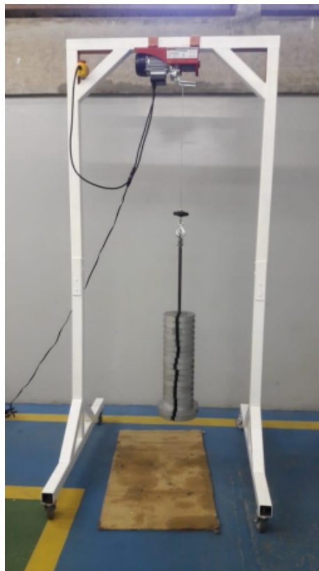
Figura 3 – Suporte parcial de peso com talha elétrica, (BEZERRA, 2018)
