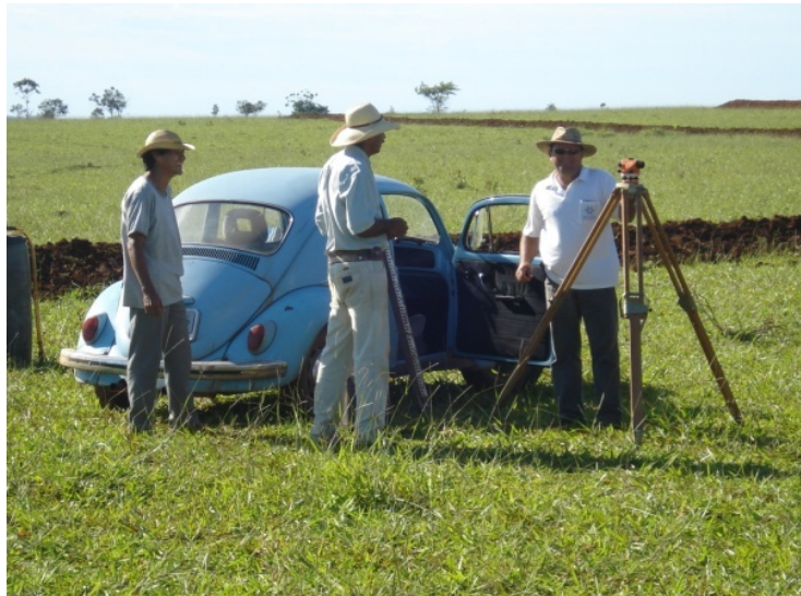
Foto 22 – curvas de nível sendo marcadas com auxílio de teodolito
