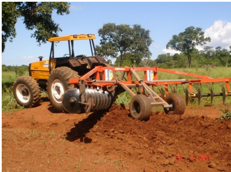
Foto 21 - Trator Valtra 1680 com o Terraceador de 18 discos, adquiridos para os projetos de conservação de solo
