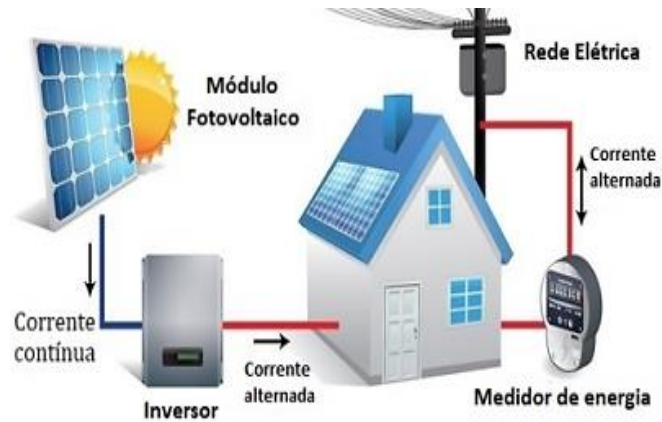
Figura 3. Sistema fotovoltaico conectado à rede.
