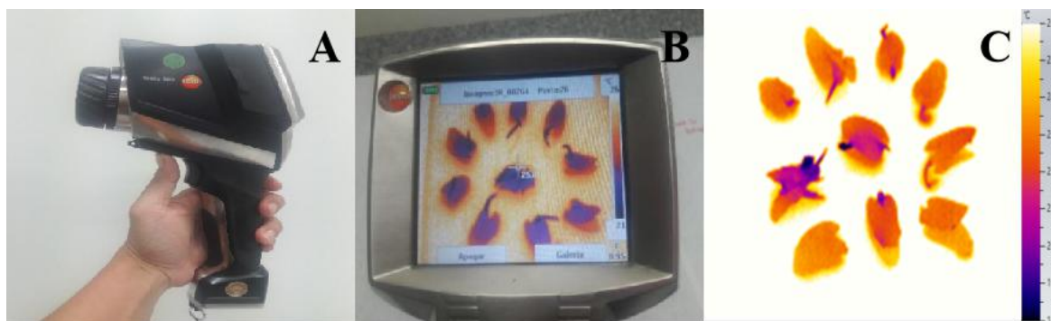
Figura 12: (A) Câmera Termográfica utilizado no experimento; (B) Imagem termográfica indicando a temperatura superficial de sementes e plântulas de Inga laurina e (C) Imagem termográfica no software. Foto: Daniela Graciano
