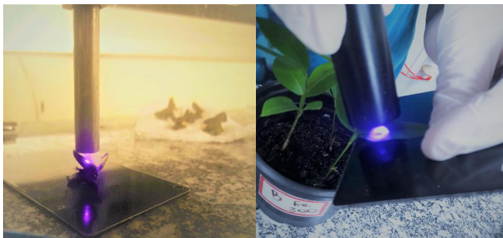
Figura 11: Obtenção dos espectros de fluorescência estacionária da clorofila a , medidas no período após embebição da semente (48h) e diariamente a cada 24h até (168h) final de período de germinação e após 30 dias. Foto: Daniela Graciano
