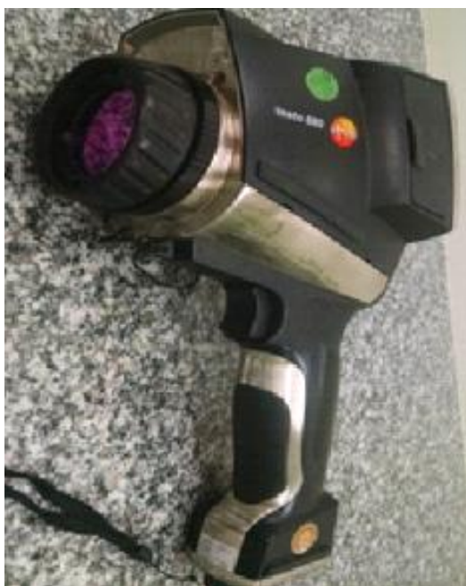
Figura 4: Aparelho de imagem termográfica utilizado (Testo 881) . Foto: Daniela Graciano
