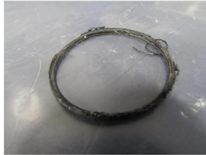
Figura 10 - Anel de vedação instalado no equipamento. Fonte: Próprio autor.
