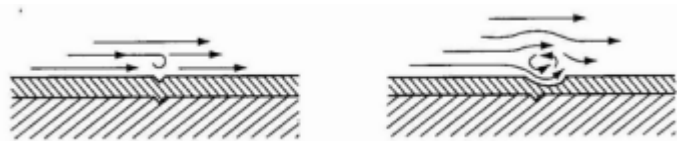
Figura 5 - Desgaste erosivo. Fonte: Tschiptschin, (2019)
