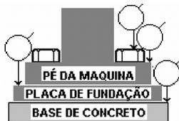
A folga Mecânica é indicada pelos espectros dos tipos A, B e C. O Tipo A é causado por folga/fragilidade Estrutural nos pés, base ou fundação da máquina; também pela deterioração do apoio ao solo, folga de parafusos que sustentam a base; e distorção da armação ou base (ex.: pé frouxo). A análise de fase revelará aproximadamente 180° de diferença de fases entre medições verticais no pé da máquina, local onde está a base e a própria base.
