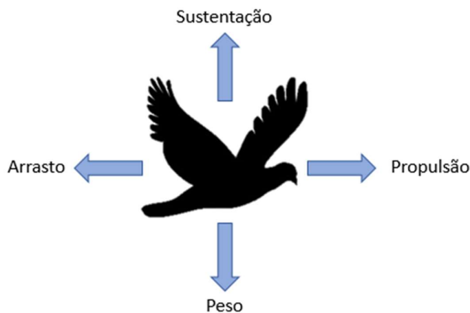
Figura 5. Representação das forças atuantes: Sustentação, Propulsão, Arrasto e Peso
