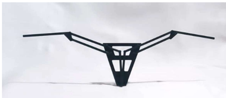
Figura 30. Protótipo fabricado por impressão 3D
